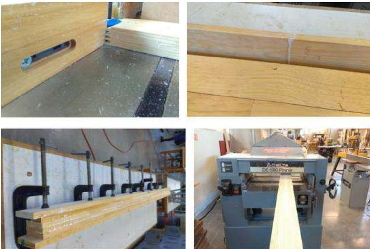
**Figura 7. Fabricación de columnas y vigas de madera laminada encolada.**
