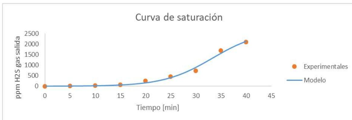
Figura 6 Ajuste de datos para la concentración inicial de 2090 ppm H<sub>2</sub>S.
