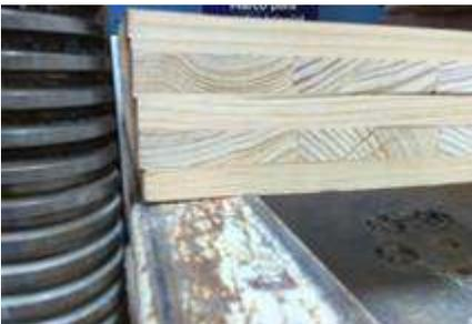
**Figura 12. Modo de falla de la losa de madera contralaminada.**
