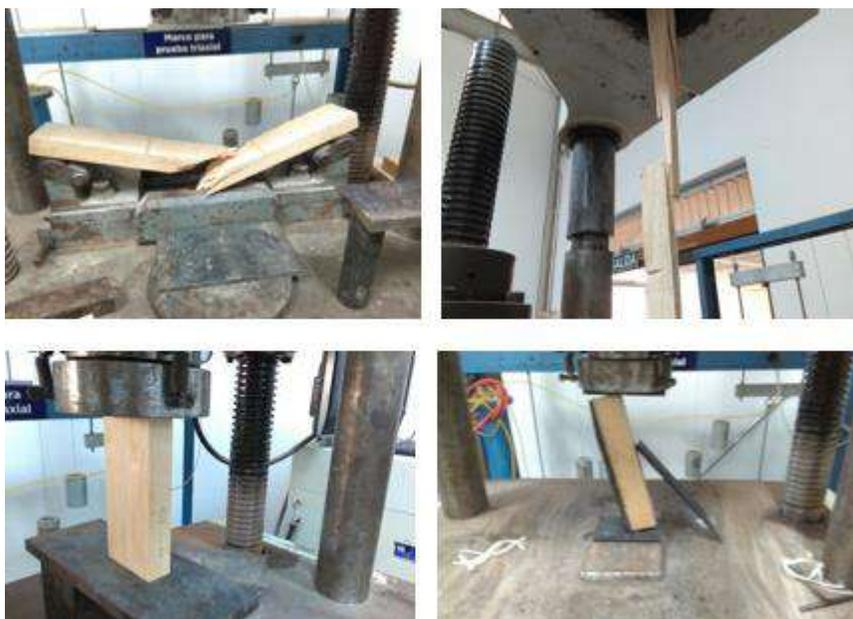
**Figura 9. Modos de falla de los ensayos de flexión, tensión, compresión y cortante.**
