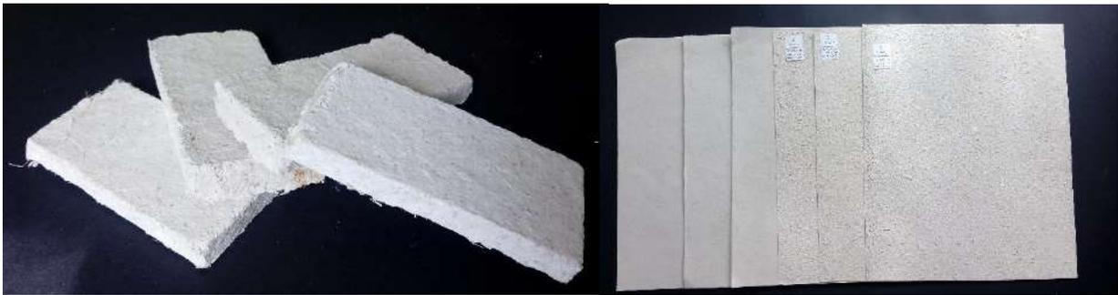
**Figura 3: Probetas de aglomerados (izquierda) y probetas de papeles (derecha).**
