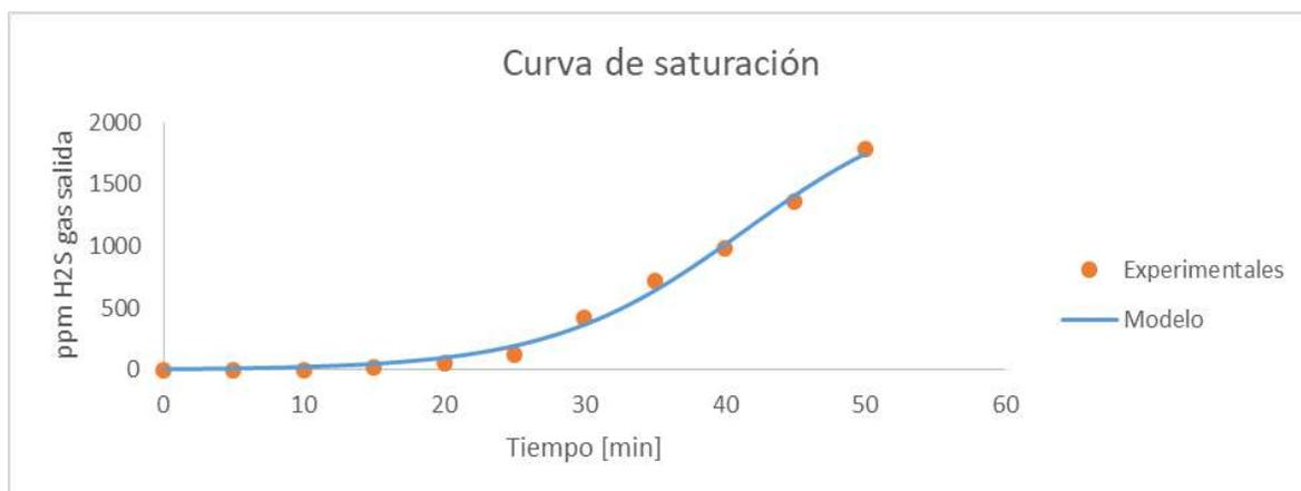
Figura 7 Ajuste de datos para la concentración inicial de 1780 ppm H<sub>2</sub>S
