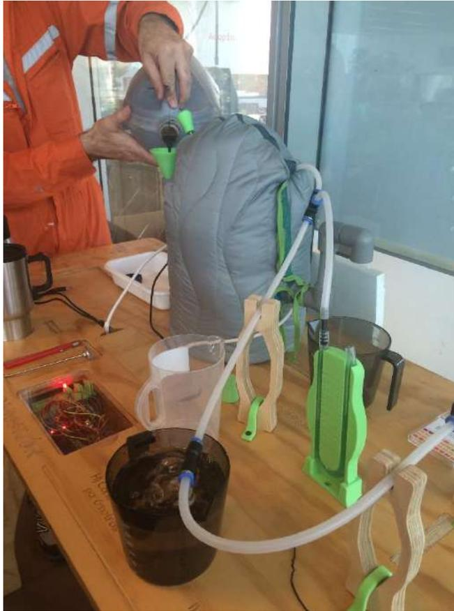
**Figura 10: Operación de inoculación del Mini Biodigestor Educativo. Ecodiseño.cl.**
