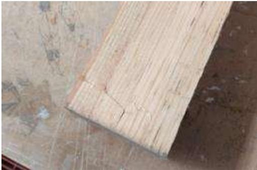
**Figura 10. Aplastamiento de la columna 1.**
