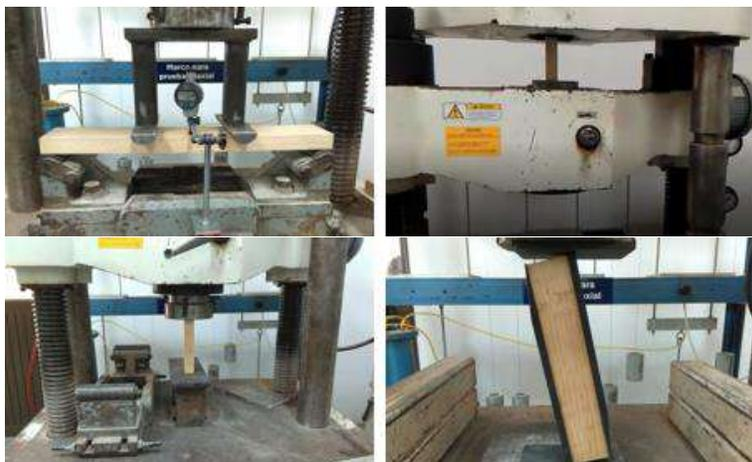
Figura 3. Configuración de ensayos de flexión, tensión, compresión y cortante de acuerdo a la norma EN 408 (2004).
