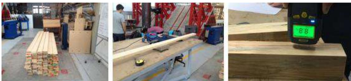
Figura 2. Proceso de clasificación por densidad.
