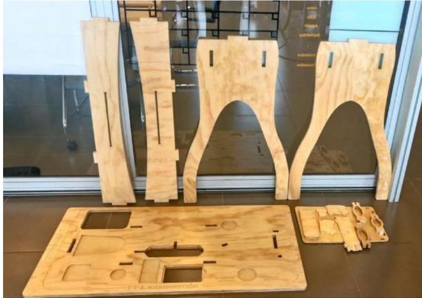
Figura 5: Partes del soporte del Mini biodigester desarrolladas en Router CNC. Ecodiseño.cl.
