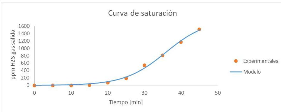
Figura 8 Ajuste de datos para la concentración inicial de 1510 ppm H<sub>2</sub>S.
