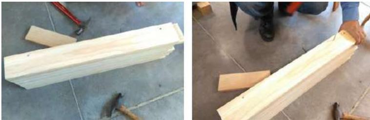
**Figura 6. Fabricación de losas de madera laminada clavada.**
