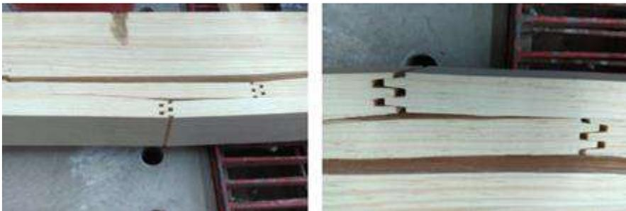
**Figura 11. Modo de falla de la viga de madera laminada encolada.**
