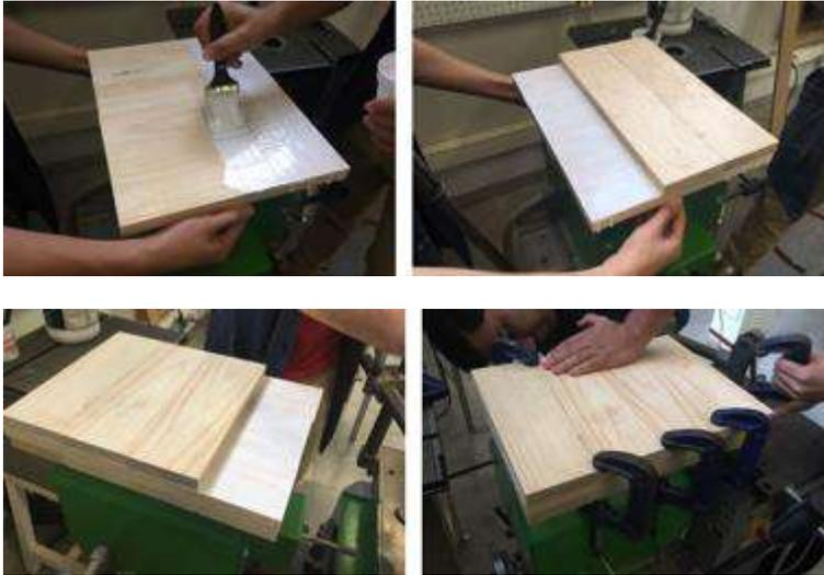
**Figura 4. Fabricación de muros de madera contralaminada.**
