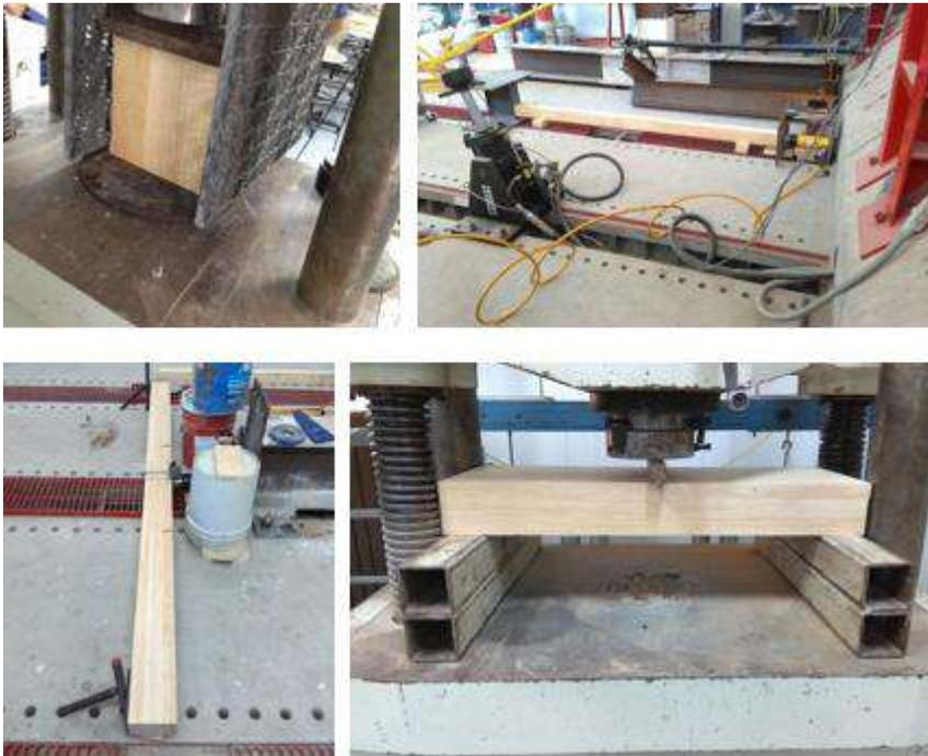
**Figura 8. Configuraciones de los ensayos de los elementos estructurales.**
