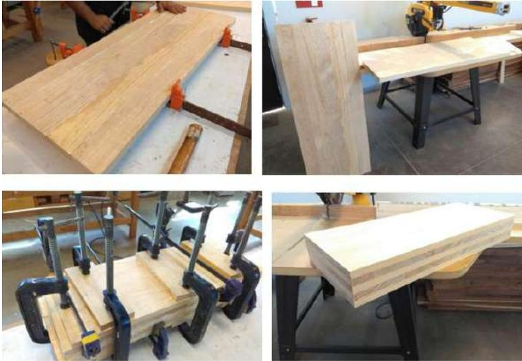
**Figura 5. Fabricación de losas de madera contralaminada.**
