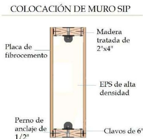
**Figura 1.- Colocación de muros estructurales en una edificación con el sistema SIPS.**
