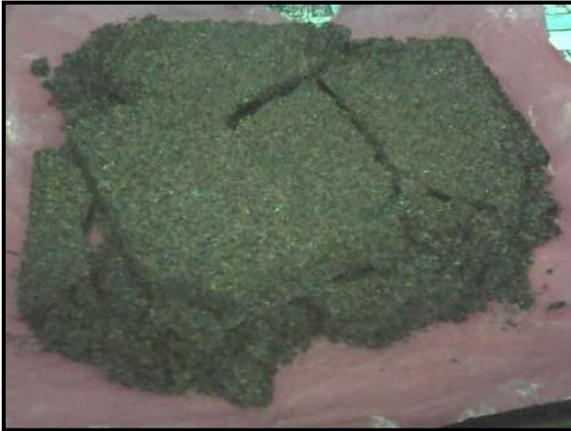
Los tableros aglomerados se desintegraron completamente, el único tablero que no se desintegró totalmente fue el elaborado con partículas de malla 20 con un 4% de resina. Los tableros obtenidos se muestran en la figura 6.
